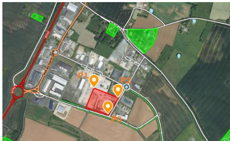
Figure 13 : Réseau de surveillance des retombées de poussières
